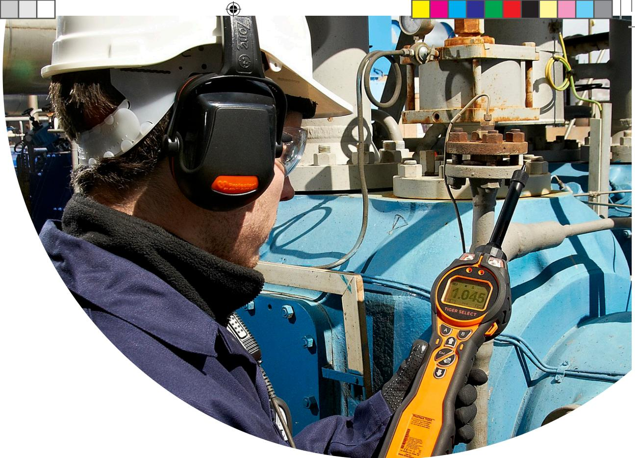
Détecteur portable révolutionnaire, le Tiger Select peut fonctionner soit avec un tube de pré-filtrage du benzène, pour détecter sélectivement celui-ci, soit sans ce tube, pour détecter l'ensemble des composés aromatiques (TAC). À titre de simplicité d'utilisation, le Tiger Select est en deux modes conviviaux : Élémentaire et Avancé. Les deux modes peuvent être sélectionnés par l'utilisateur.
